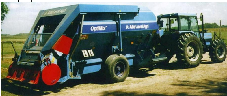
Рис. 123. Кормозмішувач–роздавач DeLaval з навантажувачем силосу
