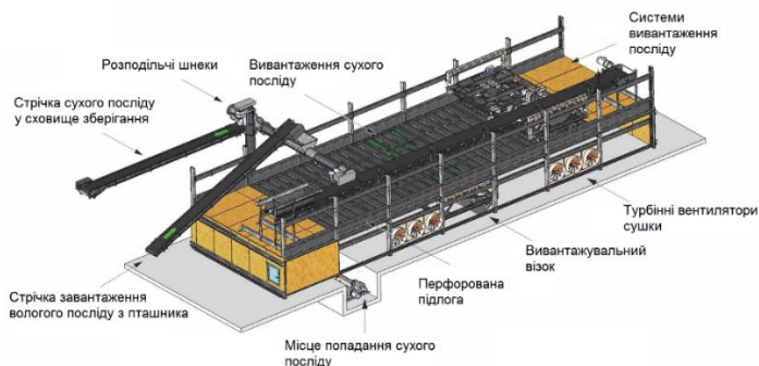
Рис. 176. Установа для сушіння пташиного посліду Secopov
