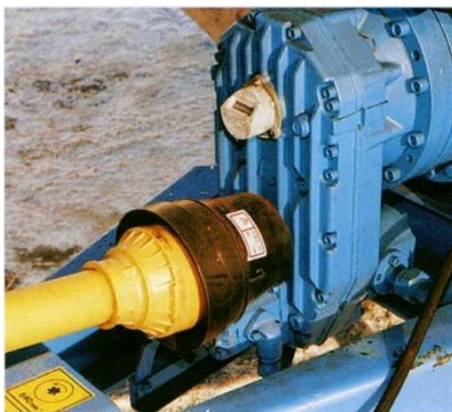
Рис. 124. З'єднання ВВП трактора з гідравлічною системою роздавача DeLaval
