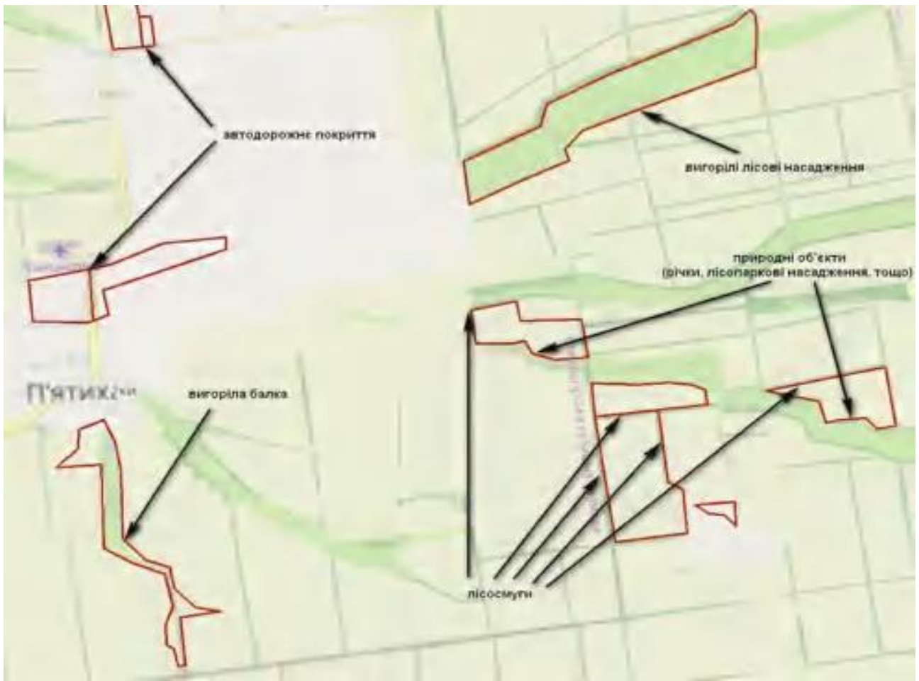
Рисунок 4.12 — Бар'єри, що перешкоджають просуванню вогню на сусідні ділянки (у якості топоосної наведено дані сервісу OpenStreetMap)
