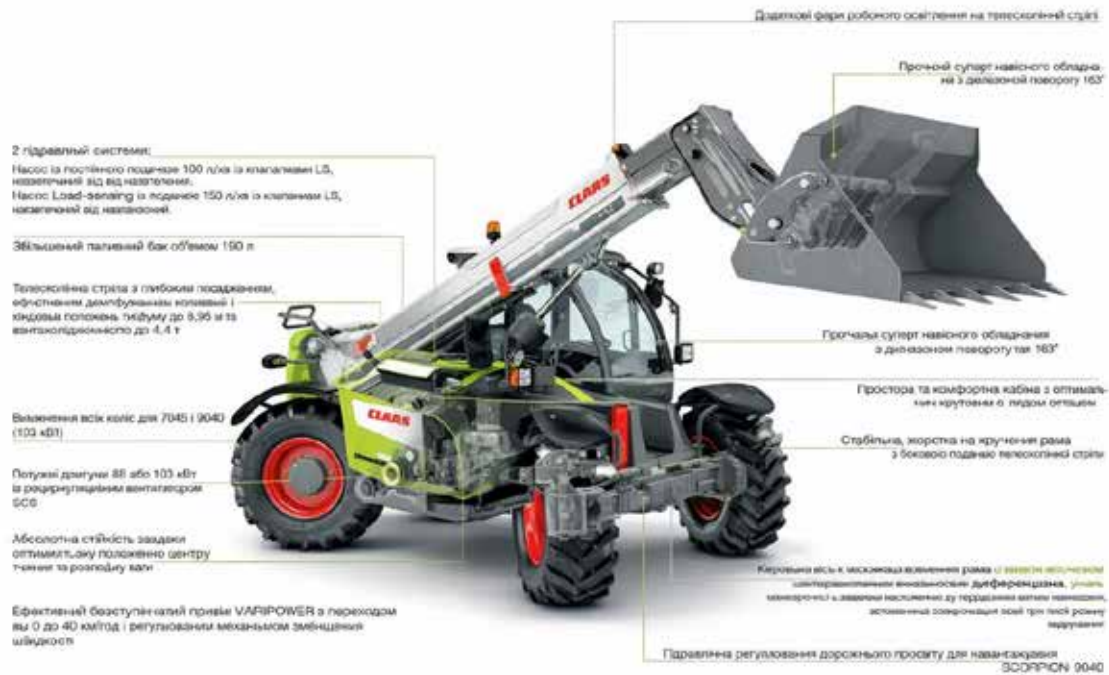
Рис. 1. Модель телескопічного навантажувача SCORPION CLAAS моделі серії 90
