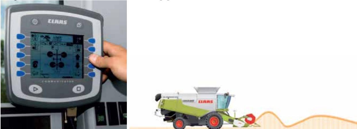
Рис. 1. ISOBUS-сумісний термінал COMMUNICATOR
