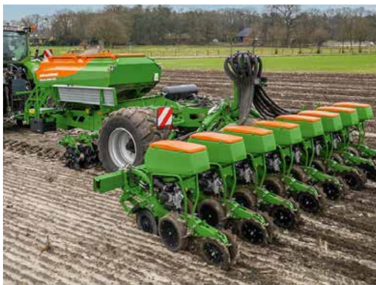
Рис. 3. Сівалка точного висіву Precea 6000-TSS з окремими бункерами
