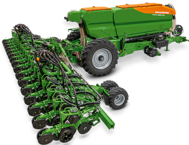
Рис. 2. Сівалка точного висіву Amazone Precea зі спільним бункером («seed wagon»)
