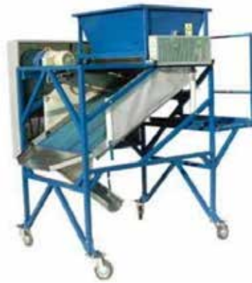
Рис. 2. Машина для розділення зібраної сухої ромашки на стебла та суцвіття OGK 1003-A
