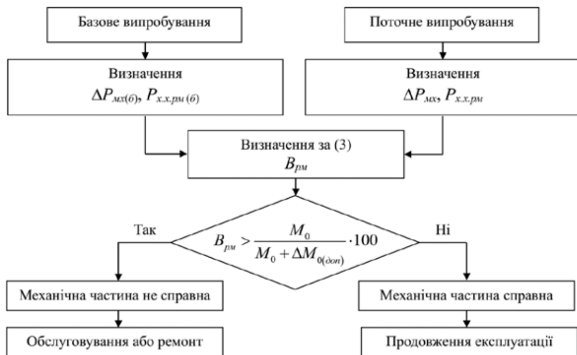
Рис.2. Блок-схема періодичного контролю функціонального стану механічної частини робочої машини.
