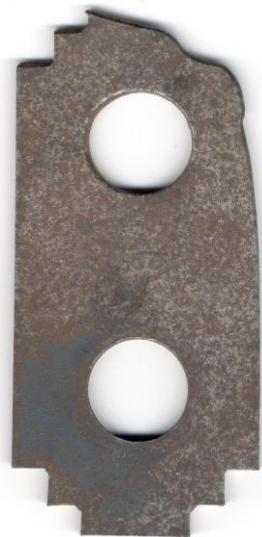
Рис.1.6. Изношенный молоток дробилки
