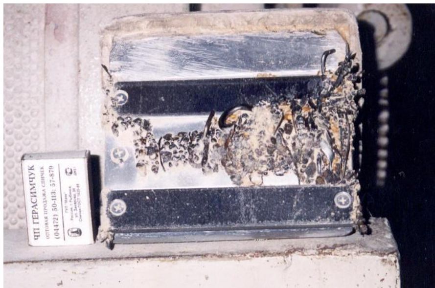
Рис.3.11. Образование „магнитных шунтов” в сепараторах типа МАП.
