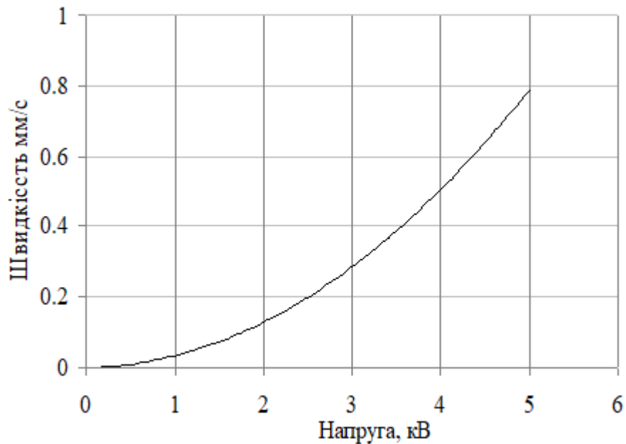
Рис. 3.39. Залежність швидкості частинки в момент стикання з електродом від напруги
