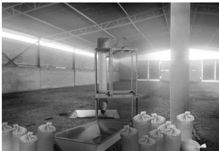
Рисунок 5.1 – Віброаспіраційний сепаратор ВАС–7 під час сепарації насіння соняшнику у СФГ «ВІТА»
