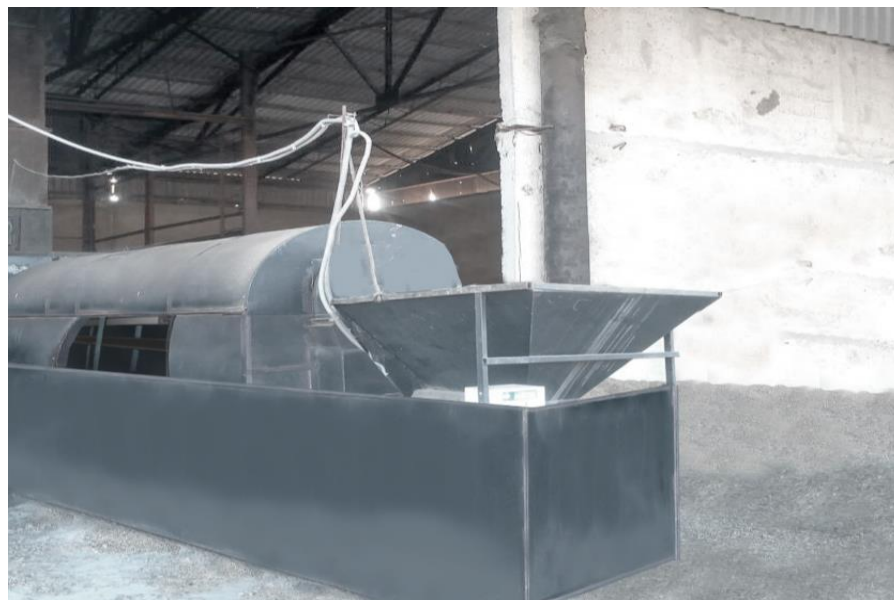
Рисунок 5.3 – Віброконвеєрна інфрачервона сушарка, яка застосовувалась у ТОВ “Агрофірма Ольвія”
