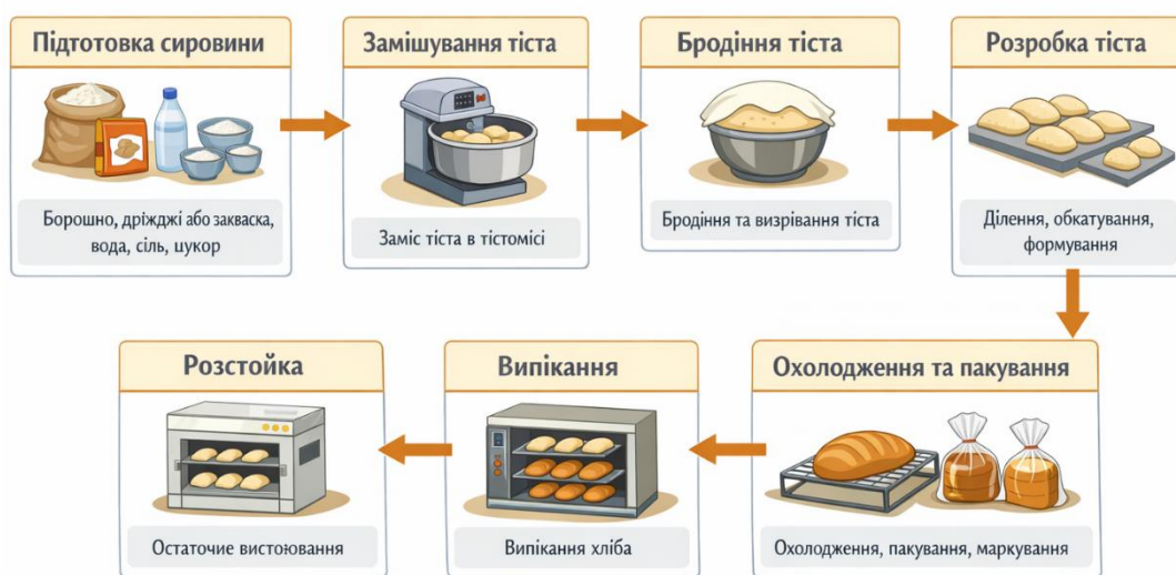
Рисунок 2.1 – Технологічна схема виробництва хліба та хлібобулочних виробів
