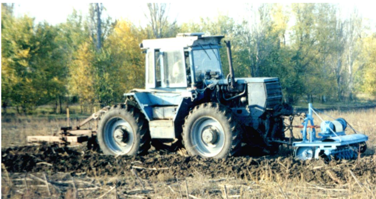
Рис. 9. Комбінований МТА для основного обробітку ґрунту на базі трактора ХТЗ-120 в роботі.
