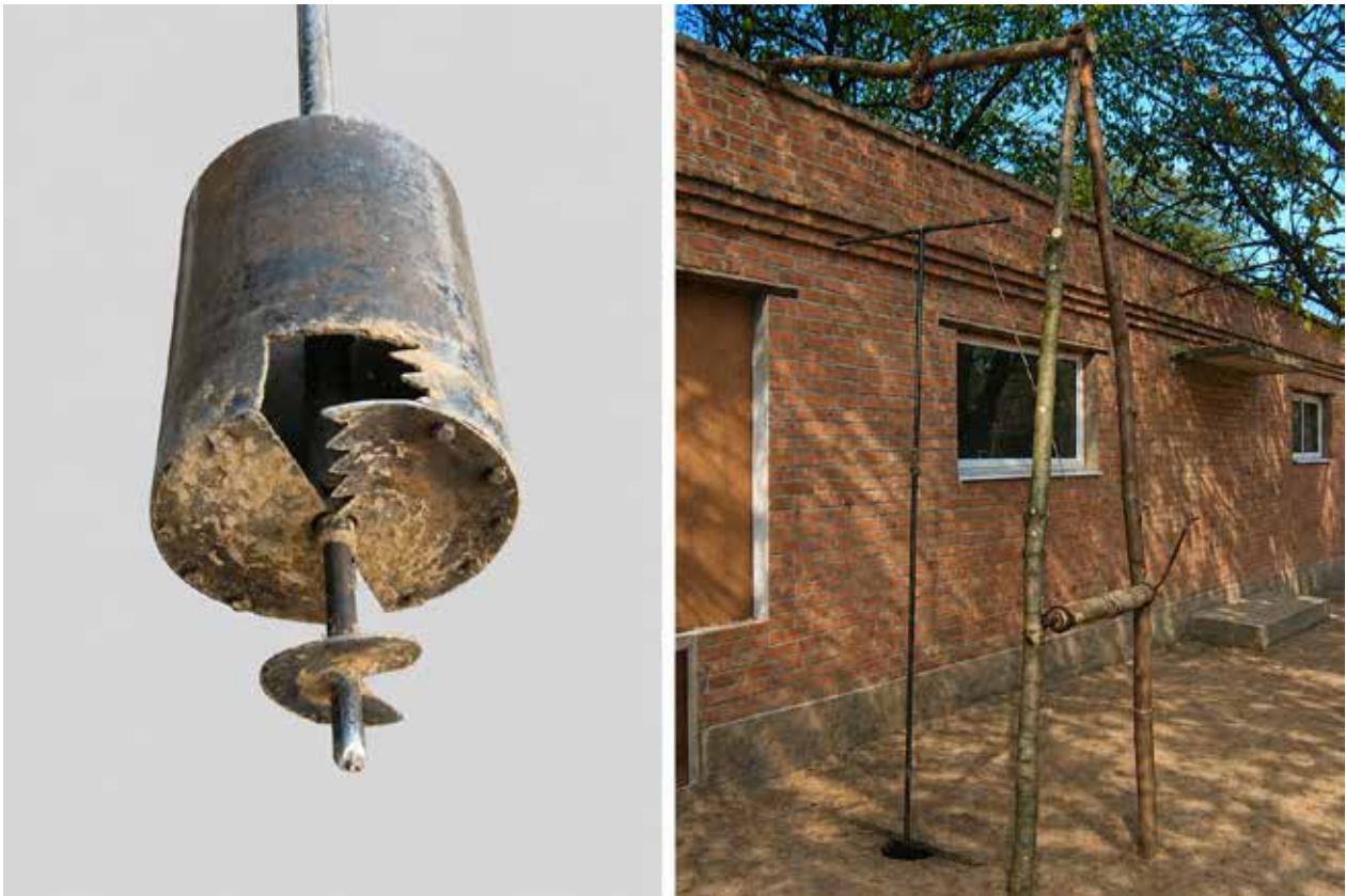
Рис. 1. Обладнання та ділянка ручного буріння свердловини: а – робоча частина ручного бура; б – загальний вигляд ділянки буріння
