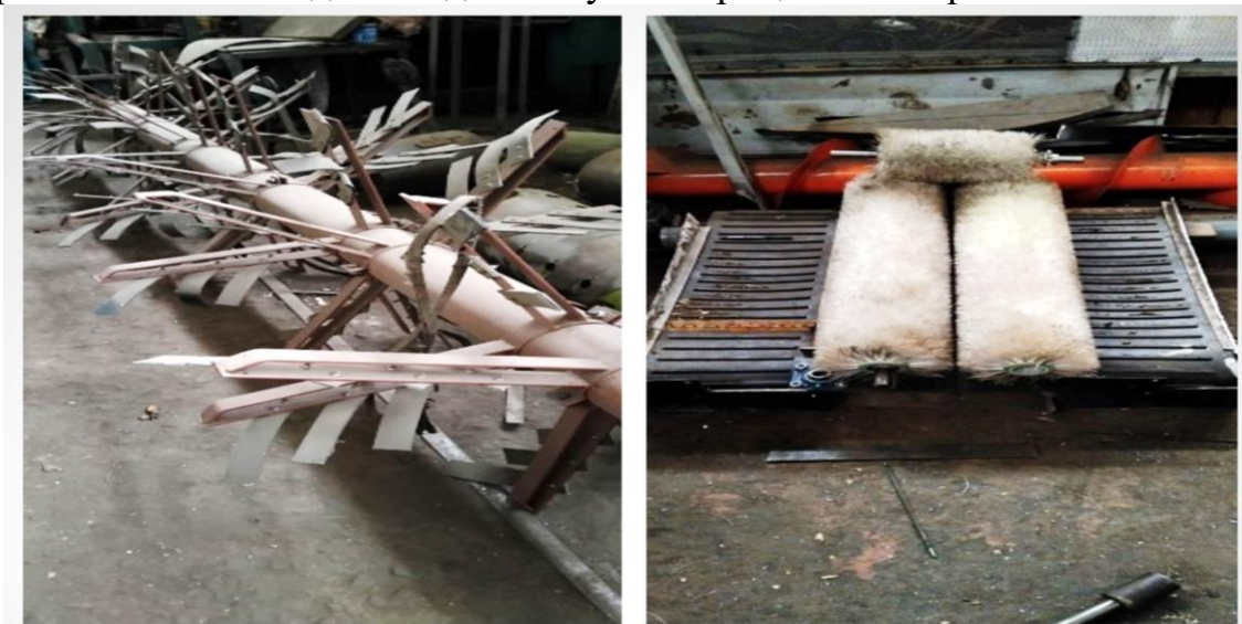
Рис.2. Експериментальне обладнання для очісування рицини на корені
