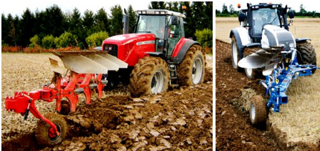
Рис. 3. Приклади розташування опорного колеса фронтального плуга у борозні
