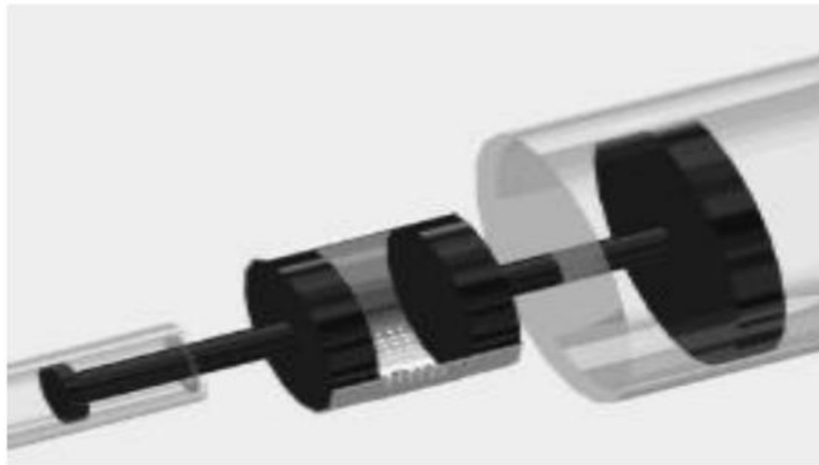
Рис. 1. Поздовжній переріз механічного преса періодичної дії
