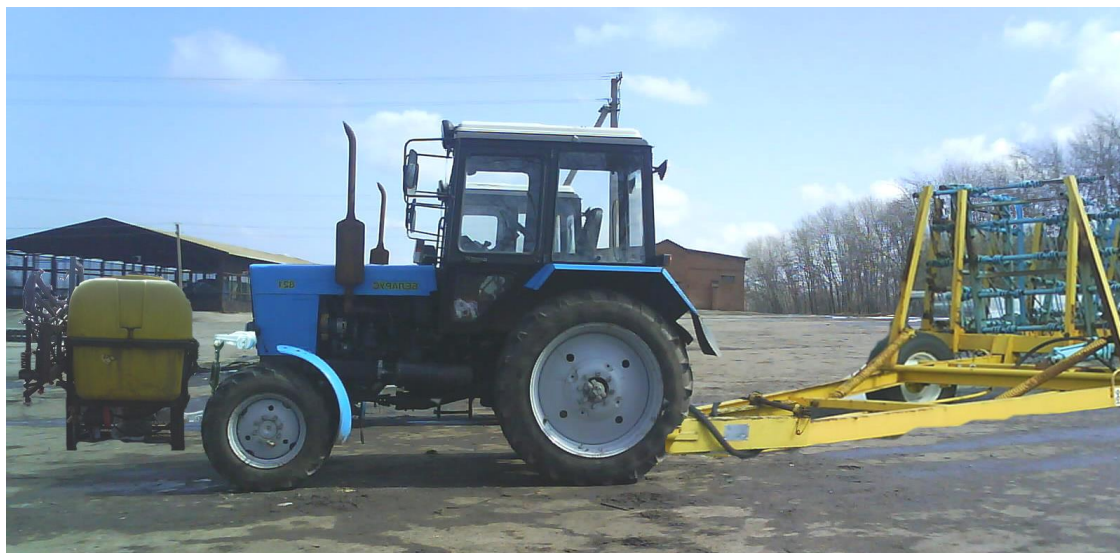
Рис. 3. Комбінований МТА на базі трактора МТЗ-82.1 з фронтально розташованим оприскувачем «Ренау» та борону БЗП.
