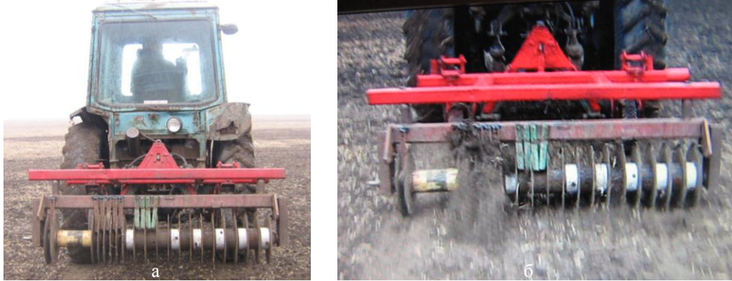
Рис. 4. Дослідний агрегат з макетом дискового ротора, набраного в батарею з дисків діаметром 400 мм, з різною відстанню між ними: 80 мм і 40 мм: а - загальний вигляд агрегату; б – агрегат в русі (видно захоплення ґрунту дисками з відстанню між ними у 40 мм).
