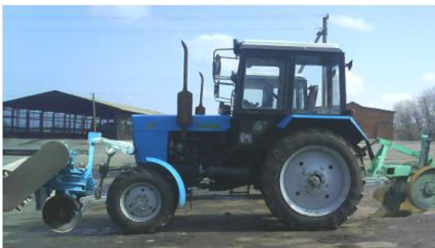
Рис. 5. Комбінований МТА на базі трактора МТЗ-82.1 з фронтально розташованим подрібнювачем ПРР-1,5 та плугом ПЛН-3-35.
