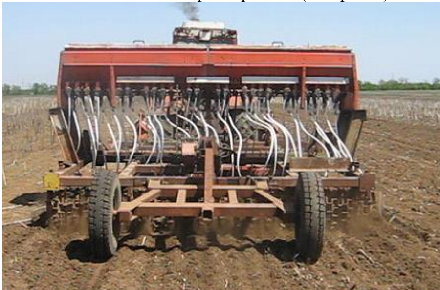
Рис. 5. Універсальний агрегат-макет для обробітку ґрунту, посіву, подрібнення й закладки сидератів на посіві.
