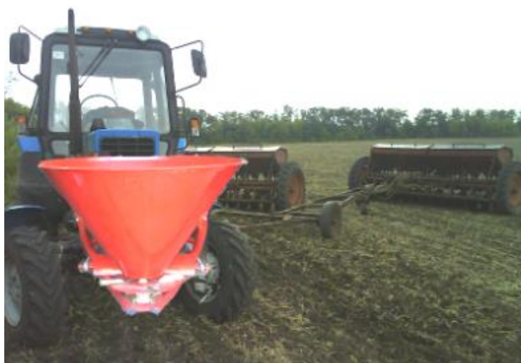
Рис. 4. Комбінований МТА на базі трактора МТЗ-82.1 з фронтально розташованим МВУ-800 та двома сівалками СЗ-3,6.
