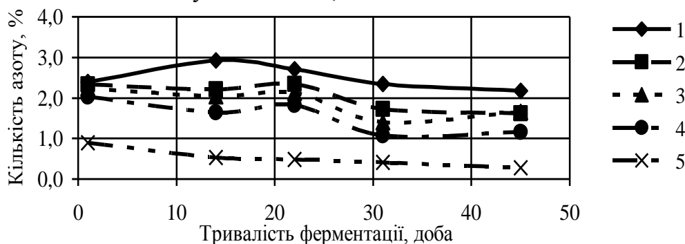
Рис. 1. Динаміка зміни загальної кількості азоту при анаеробній ферментації субстрату після вирощування гливи та курячого посліду, %.
