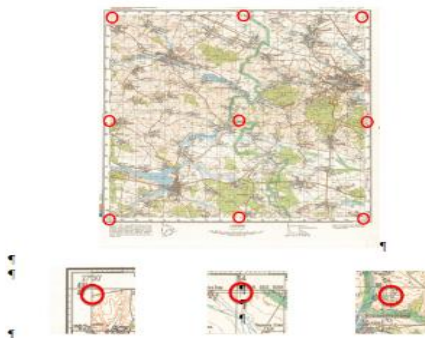
Рис. 2.9. – .1 Визначення точок трансформації по 4-х вузлових точках внутрішньої рамки та по перетинах кілометрової сітки
