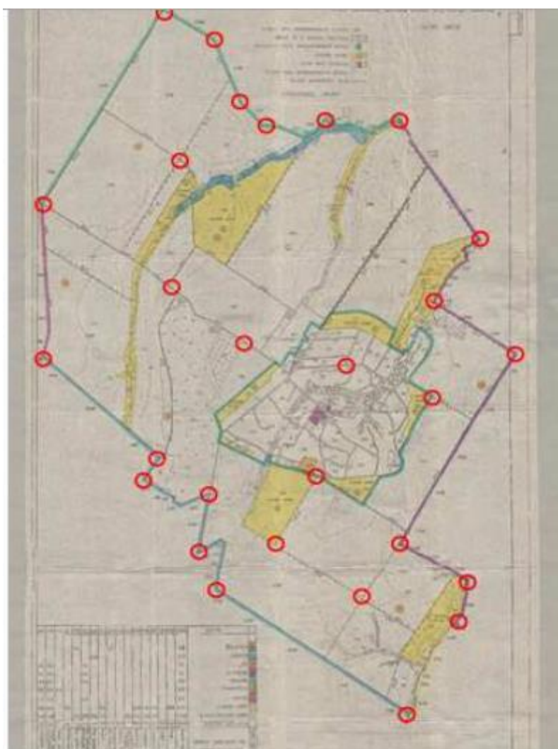
Рис. 2.27. – При виборі інтерполювання як способу трансформації растрових зображень, опорні точки розміщуються на початку та в кінці прямих ліній.
