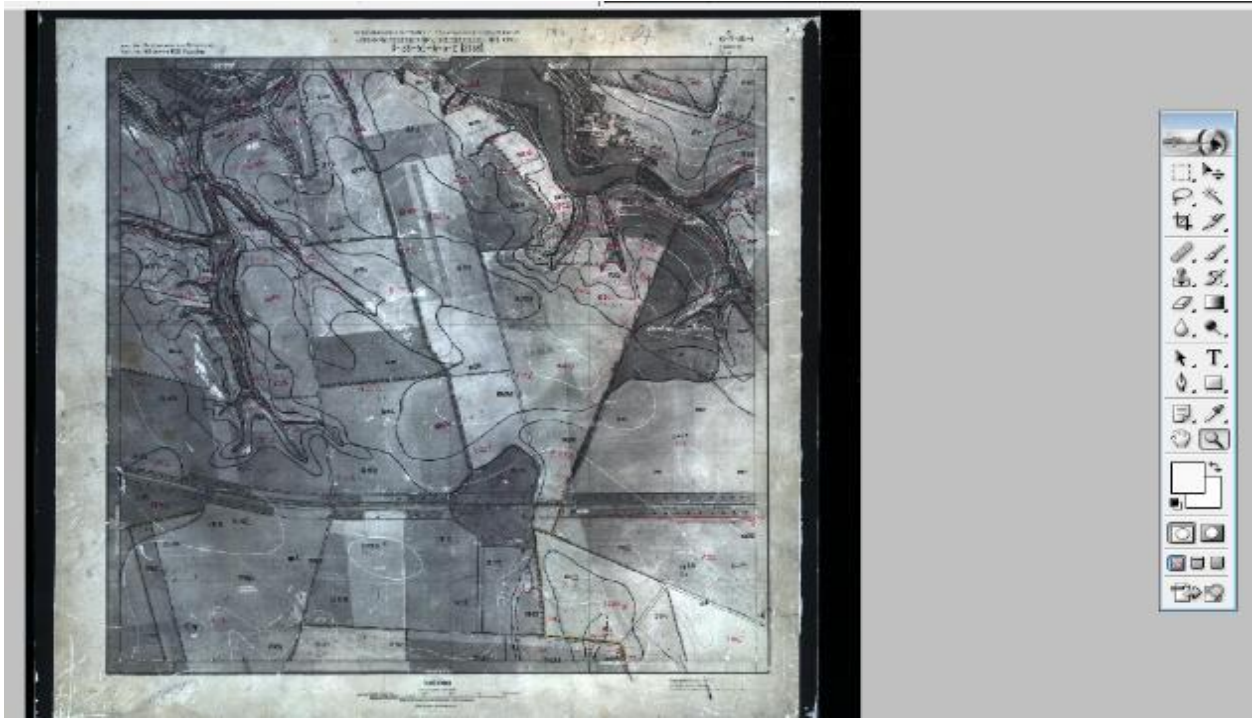
Рис. 2.11. – Визначення точок трансформації по рамці трапеції
