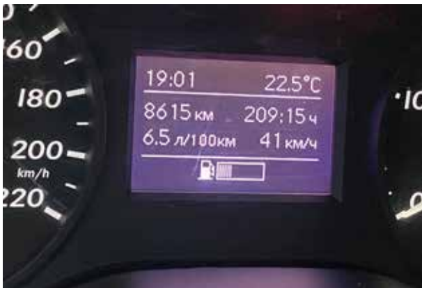
Рис. 3. Витрата палива на автомобілі Мерседес Віто 116CDI, травень-вересень 2025 р., режим експлуатації – місто
