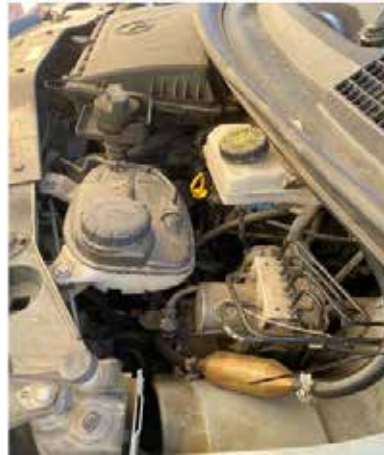
Рис. 2. Спосіб встановлення пристрою для магнітної обробки палива на автомобіль Mercedes Vito 116CDI
