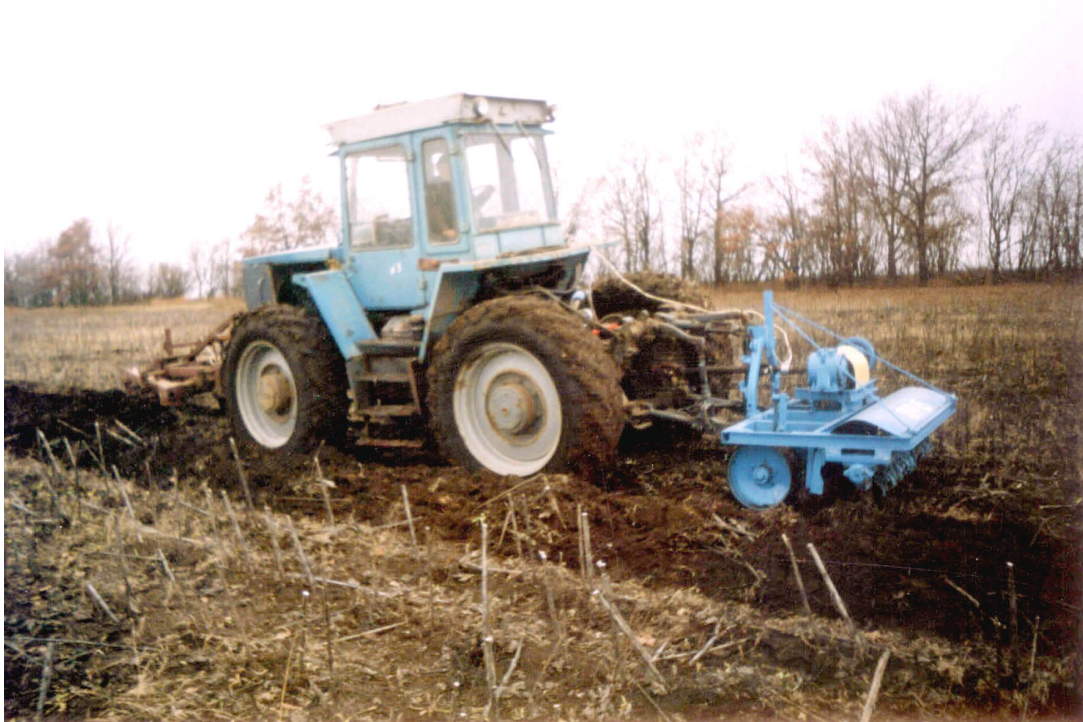
Рис. 4.3. Комбінований агрегат в роботі (агротехнічний фон - стерня соняшника)
