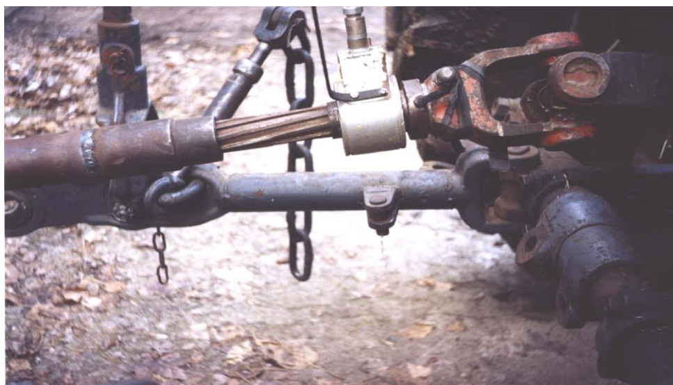
Рис.1.11. Вигляд карданного валу після включення ВВП трактора ХТЗ-120
