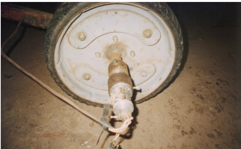
Рис. 3.8. Шляховимірювальне колесо зі струмознімачем ТРАК-6.
