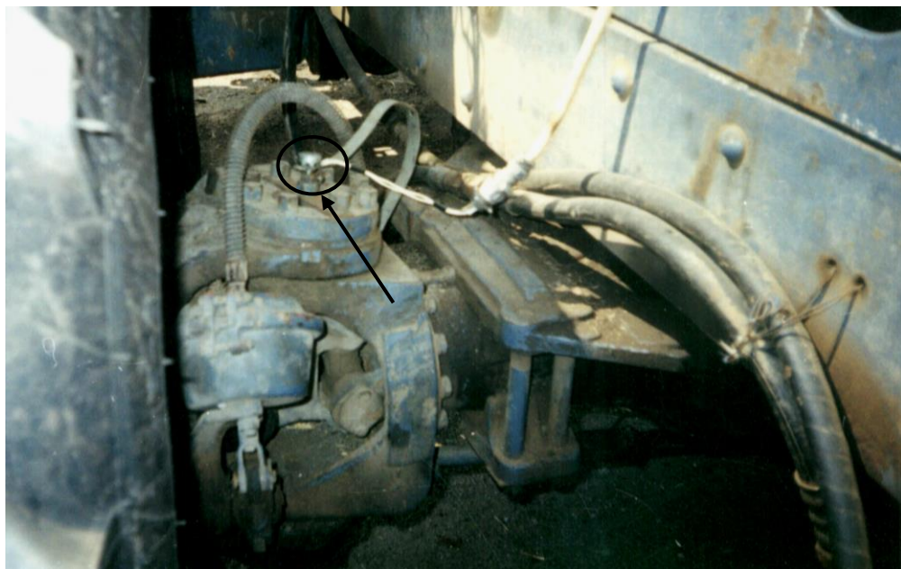
Рис. 3.16. Датчик перемінного опору СП-3А.
