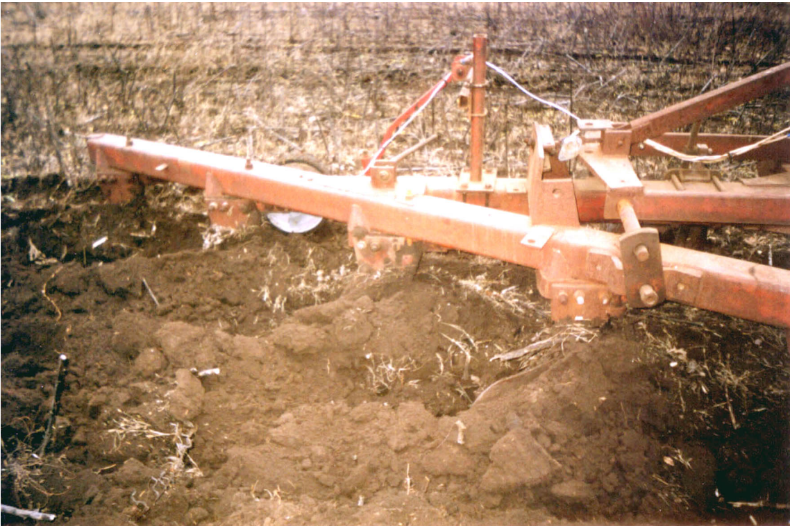
Рис. 4.11. Робота плуга при наявності подрібнювача рослинних решток.
