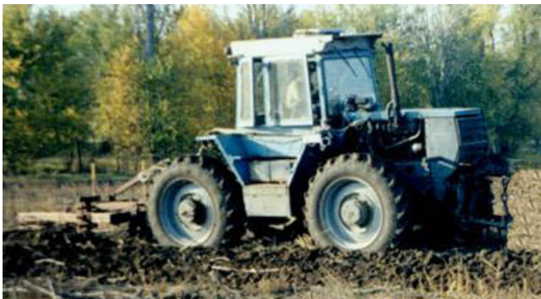
Рис. 4.16. ХТЗ-120 в агрегаті з напівнавісними плугом ПЛП-6(5)-35.
