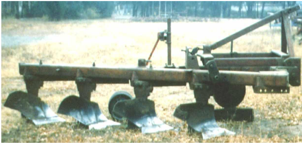
Рис. 3.2. Плуг ПЛН-5-35 з тензометричним обладнанням.
