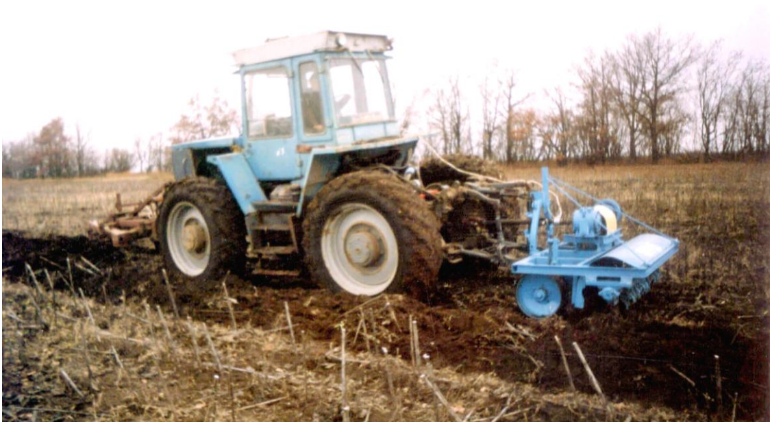
Рис. 3.1. Вид загальний комбінованого агрегату для основного обробітку ґрунту на базі трактора ХТЗ-120:
