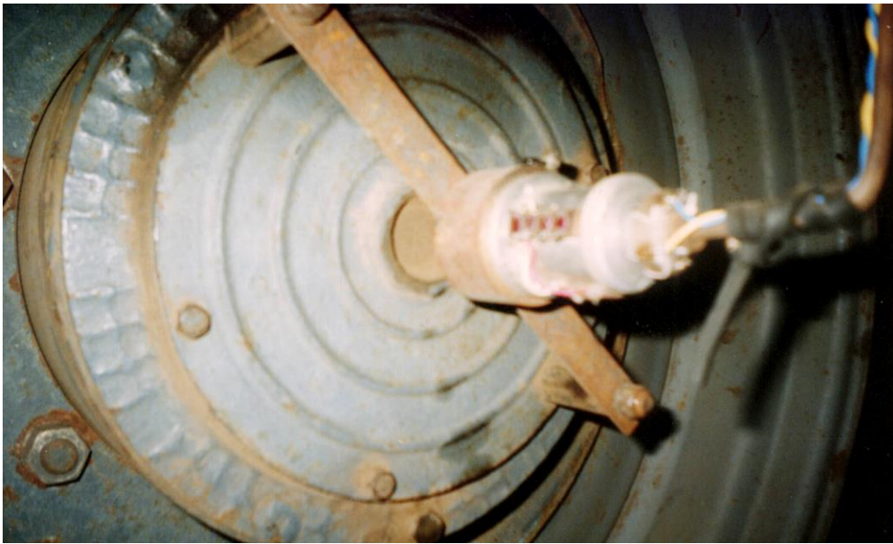
Рис. 3.10. Струмознімач для реєстрації частоти обертання коліс трактора.
