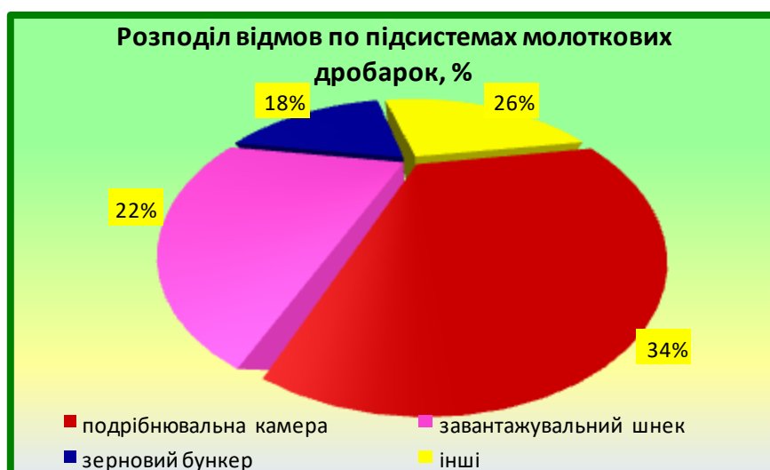
Рис. 1 - Розподіл відмов по підсистемах молоткових дробарок, %
