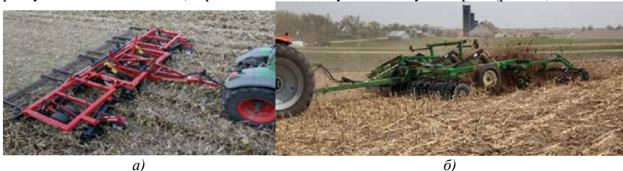
Рис. 1. Агрегат для вертикального обробітку ґрунту McFarlane SPR1000 (зліва) та Reel Disk (справа)
