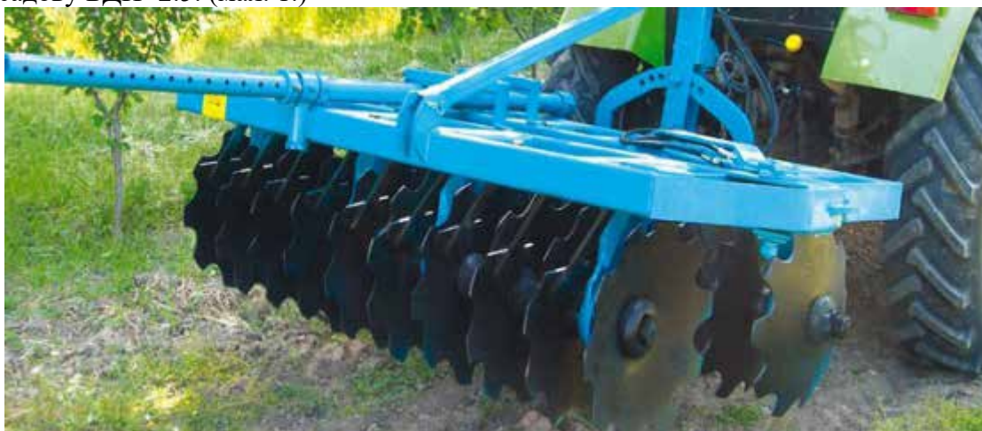
Рис. 1. Загальний вигляд борони БДН-2.5
