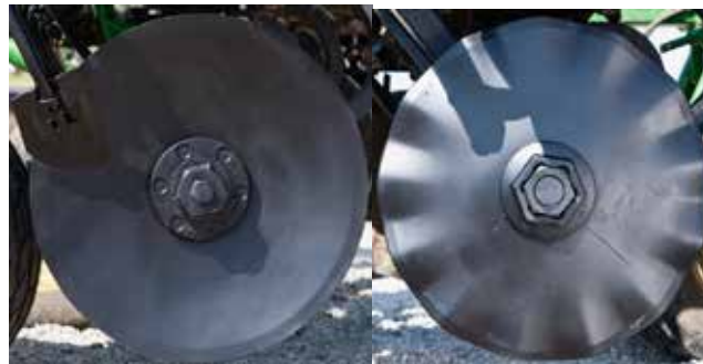
Рис. 3. Конфігурація лез дисків різних секцій машини
