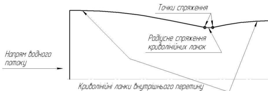
Рисунок 2 – Внутрішній перетин запропонованої конструкції фонтанних насадок
