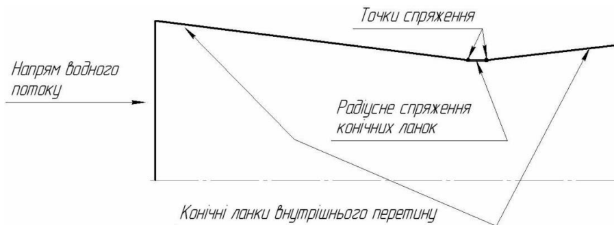
Рисунок 1 – Внутрішній перетин традиційних конструкцій фонтанних насадок
