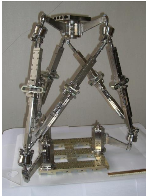
Рис. 11. Макетний зразок просторової системи приводів, з механічними приводами зміни довжини штанг
