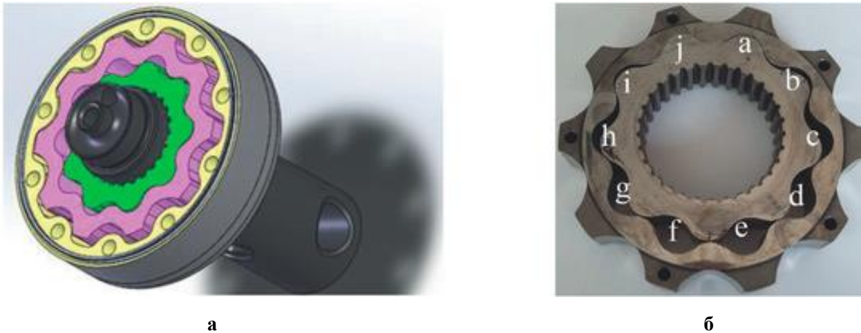
Рис. 5. Низькобортний високомоментний орбітальний гідромотор: а – конструкція; б – внутрішній і зовнішній ротори
