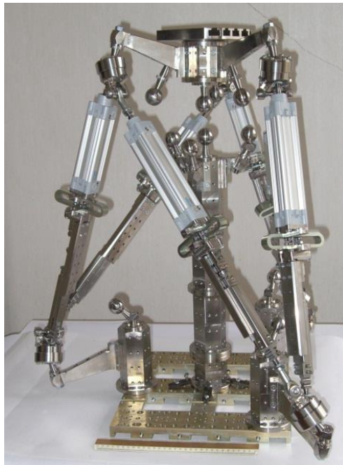
Рис. 11. Загальний вигляд дослідного зразка системи приводів побудованої на основі на основі механізму-гексаподу
