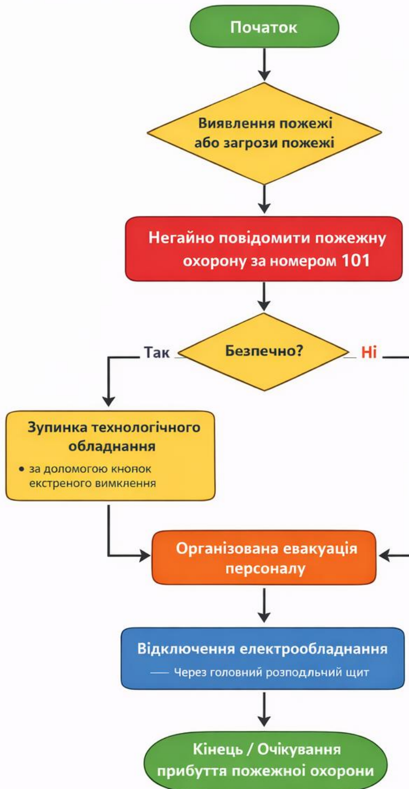
Рис. 6.1. Алгоритм дій персоналу цеху виробництва пюре у разі виникнення пожежі або загрози її поширення
