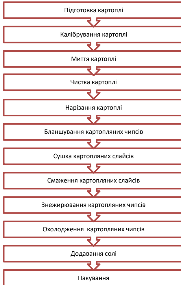
Таблиця 2.1 – Технологічна схема виготовлення картопляних чипсів.
