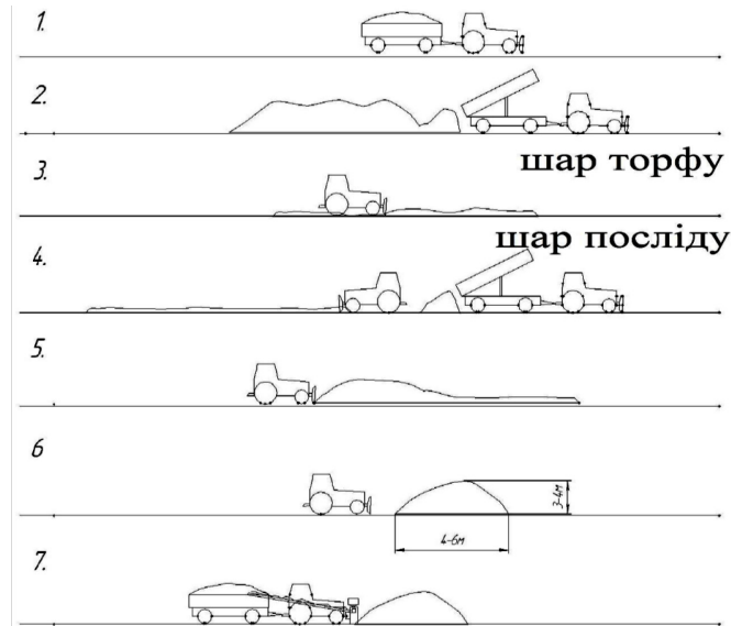
Рис. 1. Схема технологічного процесу приготування та змішування органомінерального компосту з одночасним навантаженням
