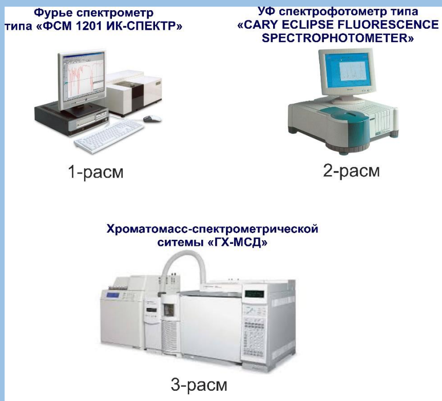
1,2,3 расм. Ёниш ташаббускорларини аниқловчи лаборатория қурилмалари
