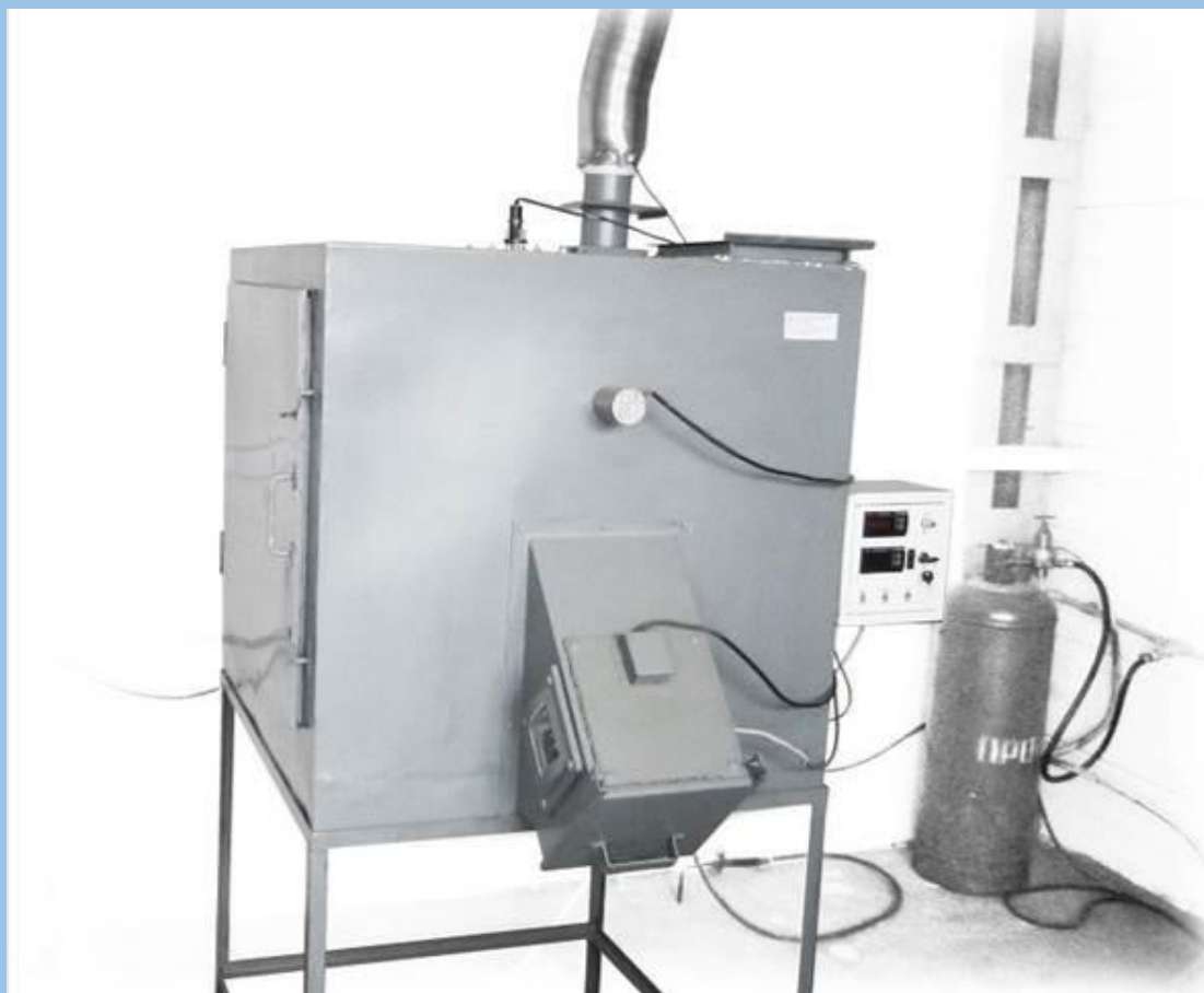
Рисунок 1. Установка исследований эффективности огнезащитных средств древесины
