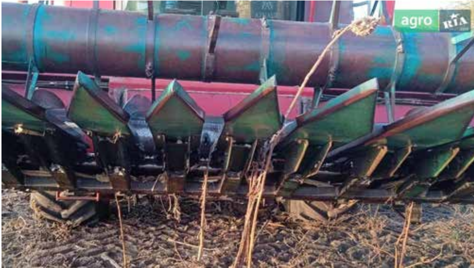
Рис. 4. Комбайн CASE 2388-Е з соняшниковою жаткою ПСП 1,5
