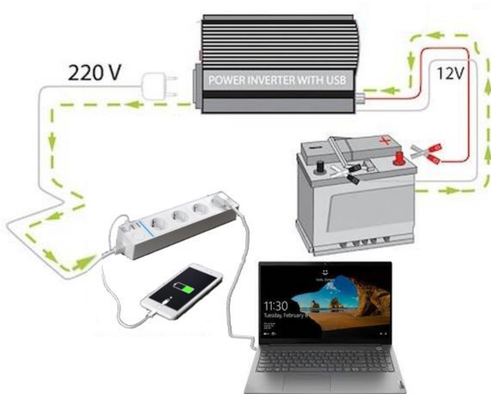
Рис. 1. Схема підключення споживачів енергії
