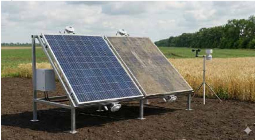
Рис. 1. Станція оцінювання забруднення сонячних модулів у польових умовах
