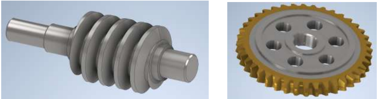
Рис. 5.4. Приклади конструкцій черв'яка та черв'ячного колеса
