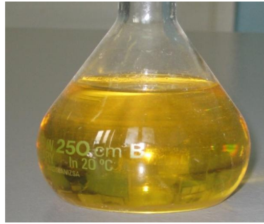
Рис. 2.8 Ємність з біодизелем обробленим ультразвуком після шести місяців зберігання
