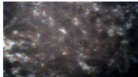
Рис. 6.30. Поверхнева структура латуні Л62 ГОСТ 1019-87
