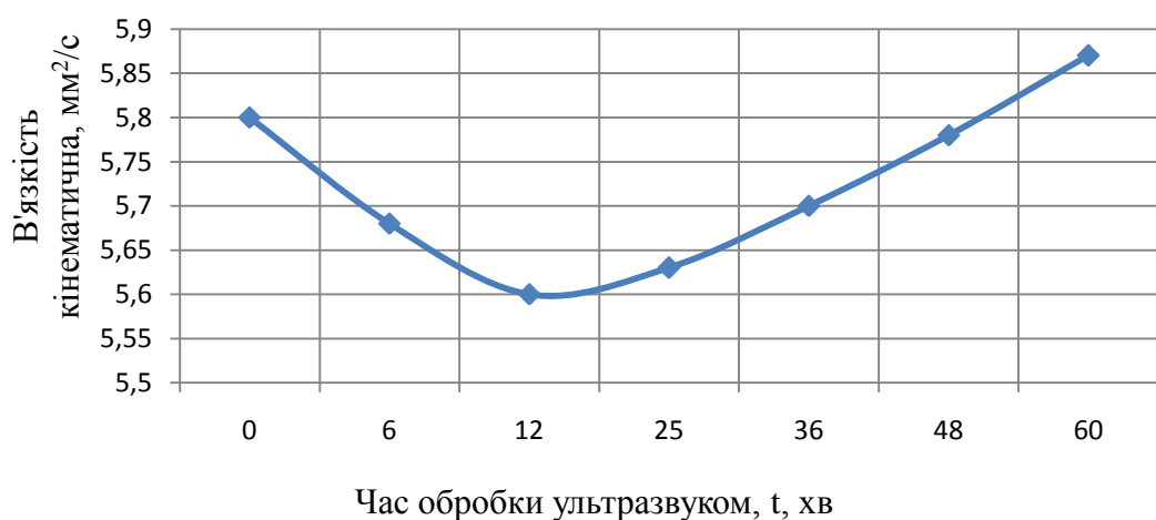
Рис. 2.9. Залежність впливу часу обробки біодизеля ультразвуком на кінематичну в'язкість
