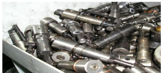
Рис. 6.35. Вибракування плунжерних пар ПНВТ за результатами випробувань
