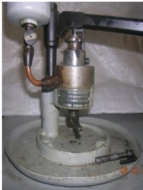
Рис. 6.38. Прилад КІ-1640А для оцінки гідравлічної щільності плунжерних пар ПНВТ
