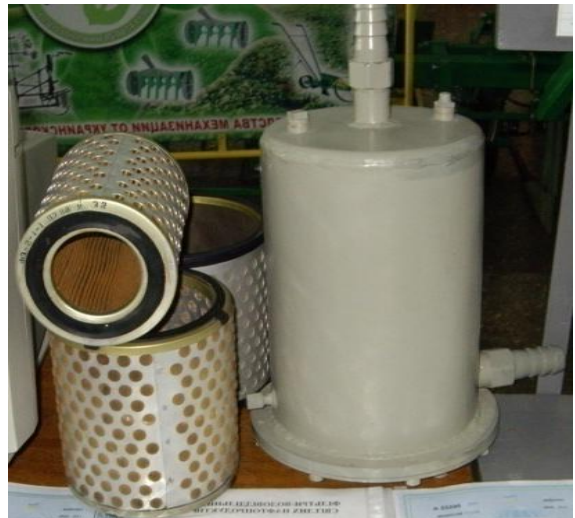
Рис. 6.49. Загальний вид фільтра грубого очищення дизельного біопального для ПРК
