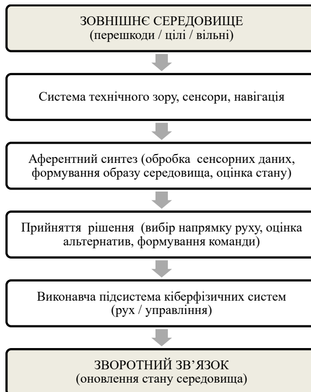
Рис. 2. Структурно-функціональна модель нейромережевого планувальника переміщення кіберфізичної системи на основі аферентного синтезу
