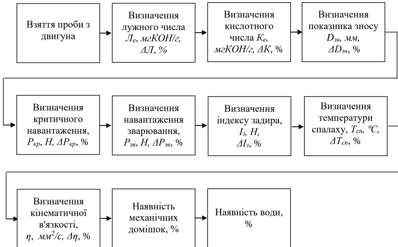
Рисунок 1 – Схема виконання аналізу проби моторної олії в процесі експлуатації
