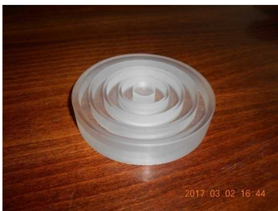
Рис. 4. Дно фільтру з профрезерованими канавками
