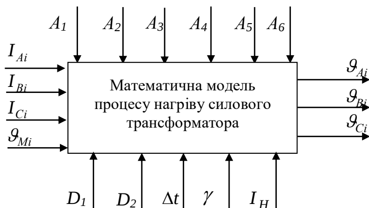
Рис. 4. Структурна схема моделі функціонального діагностування.
