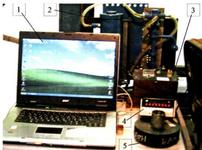
Рис. 1. Реєструвально-вимірювальний комплекс: 1 - ЕОМ; 2 - вимірювальний паливний бачок; 3 - блок живлення; 4 - 8-ми каналний АЦП; 5 - датчик обертів двигуна
