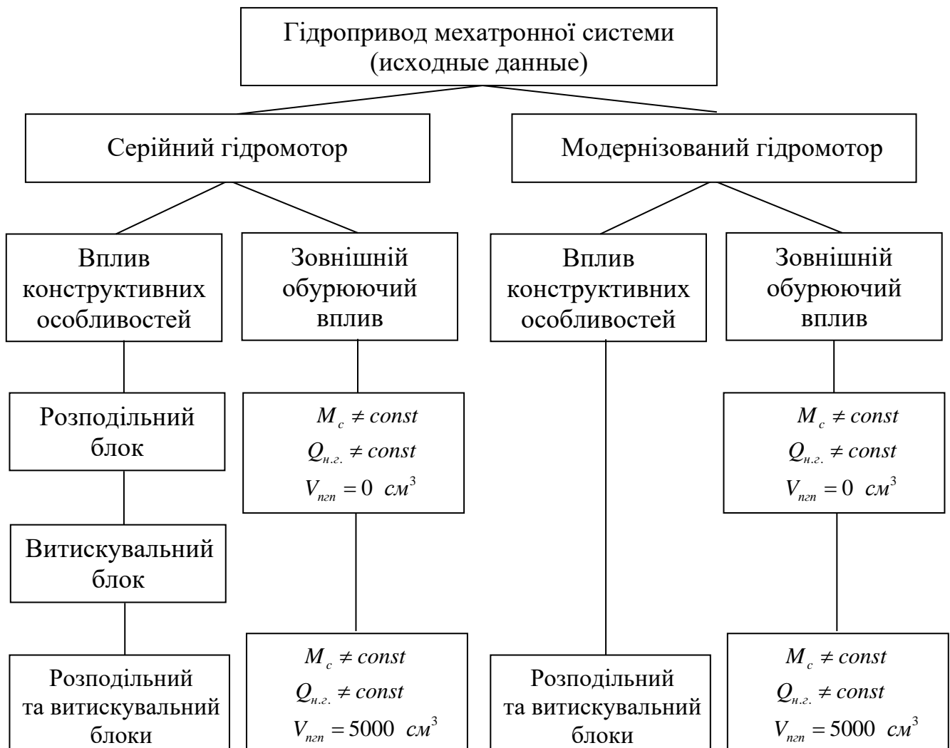
Рис. 1.1. Схема проведення досліджень динаміки зміни вихідних характеристик планетарного гідромотора у складі гідроприводу мехатронної системи
