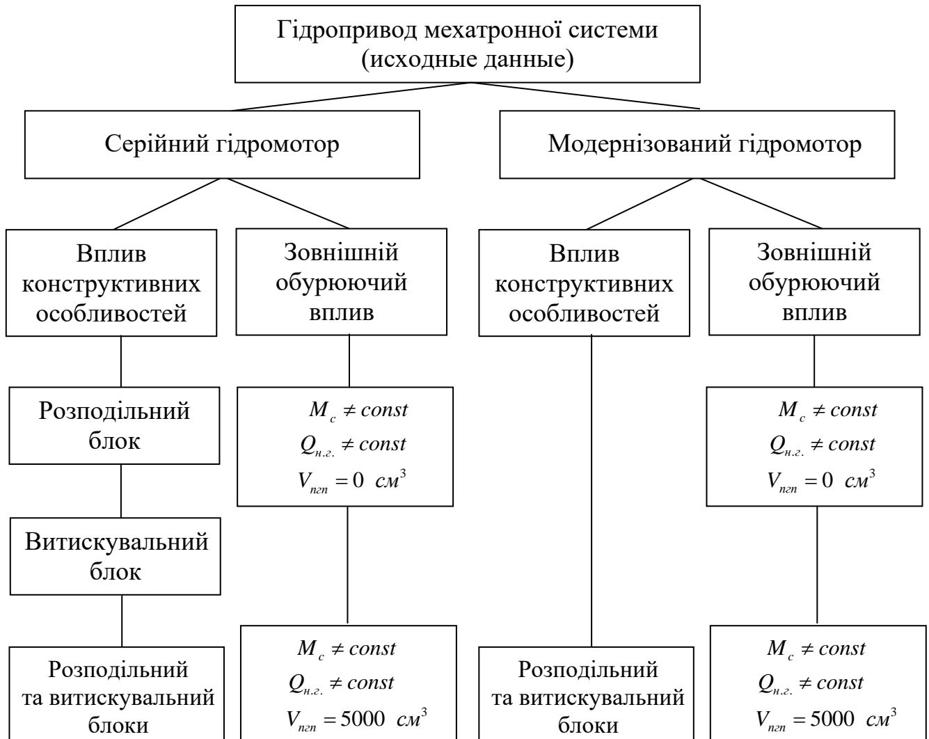
Рис. 2.1. Схема проведення досліджень динаміки зміни вихідних характеристик планетарного гідромотора у складі гідроприводу мехатронної системи
