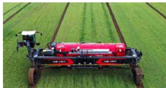
Рис. 2. Колійна система землеробства з використанням ширококолійних (мостових) тракторів
