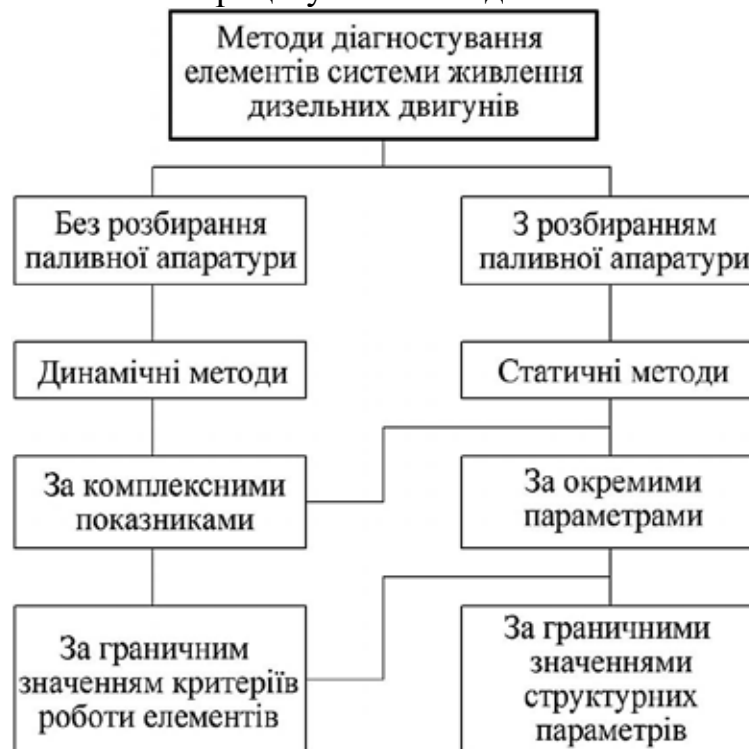
Рис. 1. Класифікація методів діагностування елементів системи живлення дизельних двигунів
