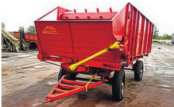
Рисунок 6.4 – Машини для роздавання кормів КТУ-10 та «Брацлав»
