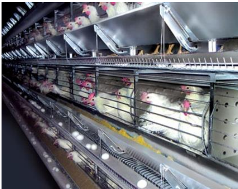
Рисунок 6.12 – Загальний вид кліткової батареї типу ТБК
