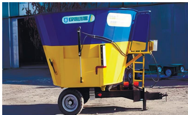
Рисунок 6.4 – Машини для роздавання кормів КТУ-10 та «Брацлав»
