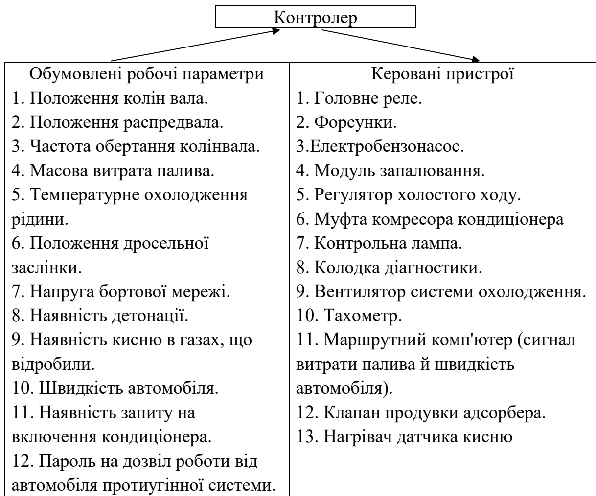
Рисунок 5.9 – Параметри та пристрої на які впливає контролер
