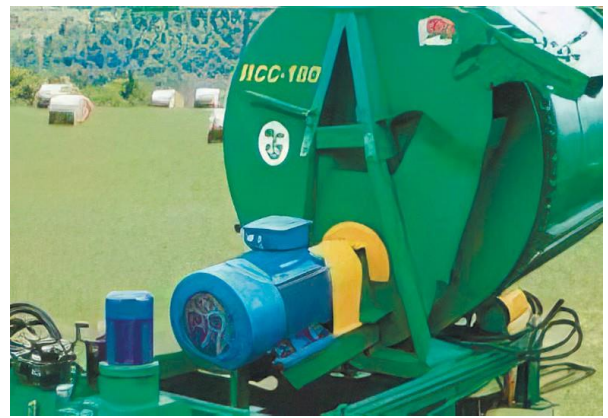
Рисунок 6.2 – Машини для подрібнення кормів ІРК-145 та ІСС-180
