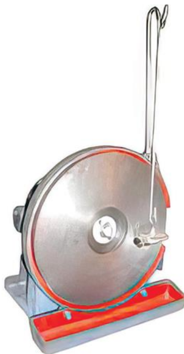
Рисунок 6.11 – Точильний апарат ТА-1 для заточування різальної пари електростригальних машинок
