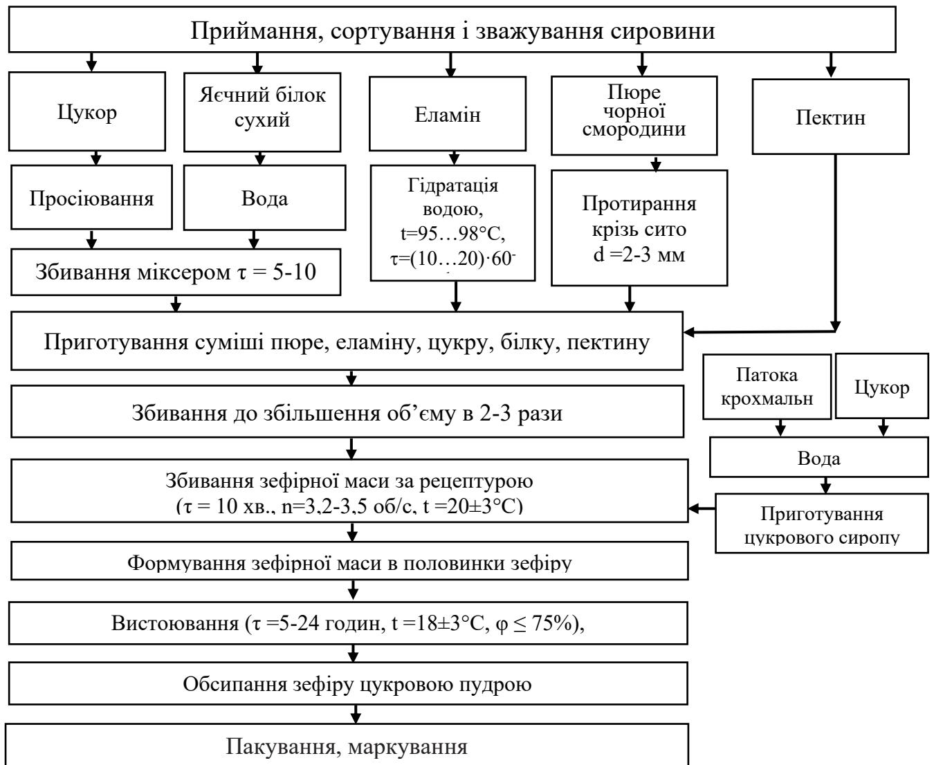
Рис. 4.2. Принципова технологічна схема виробництва зефіру з пюре чорної смородини та еламіном.
