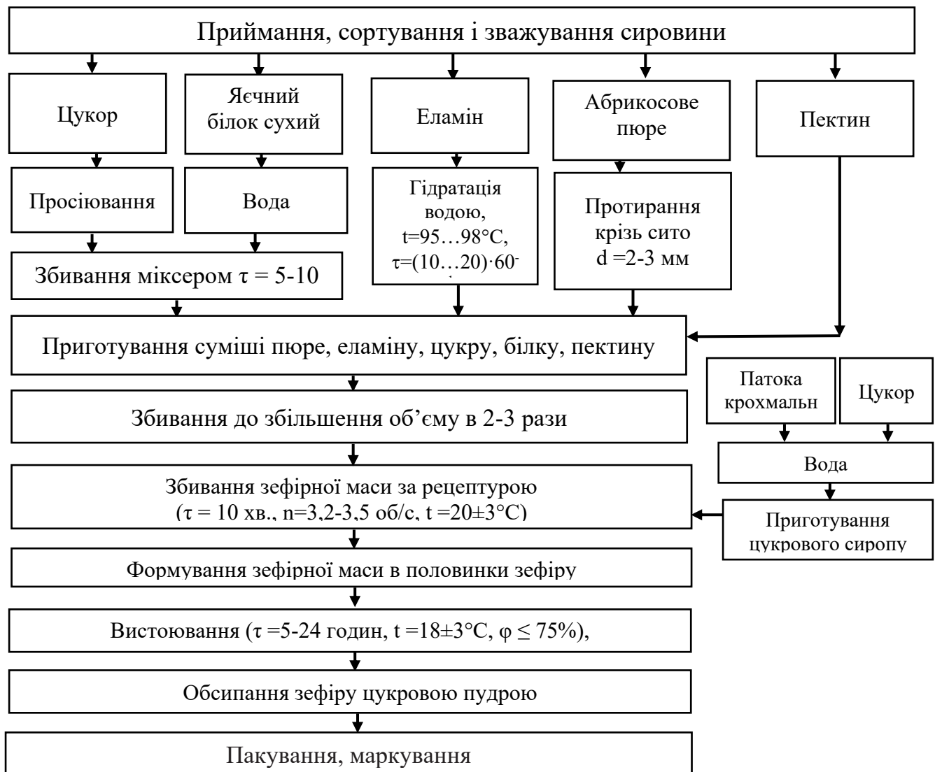
Рис. 4.1. Принципова технологічна схема виробництва зефіру з абрикосовим пюре та еламіном.
