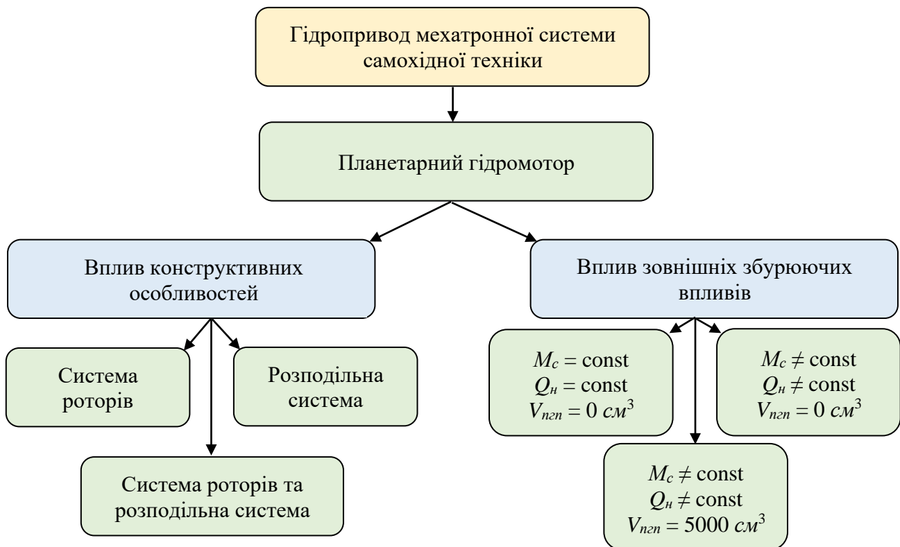
Рисунок 2 – Схема досліджень динамічних характеристик планетарного гідромотора працюючого у складі гідроприводу мехатронної системи самохідної техніки
