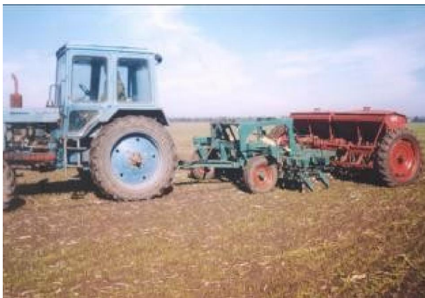
Рисунок 3.2 – Комбінований посівний агрегат ППА-3,6 в агрегаті з трактором МТЗ–82
