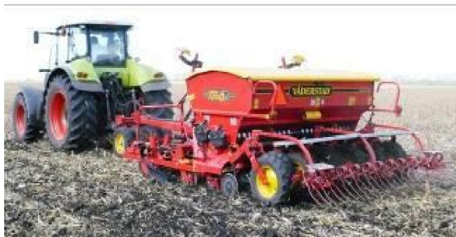
Рисунок 3.5 – Багатофункціональний посівної агрегат Rapid RD300C в агрегаті з трактором Axion 830
