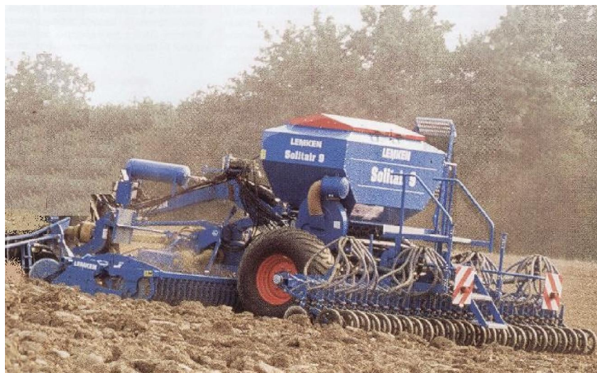
Рисунок 1.25 – Комбінований посівний агрегат Компактор К / 500А + Солітер 9 / 500КА
