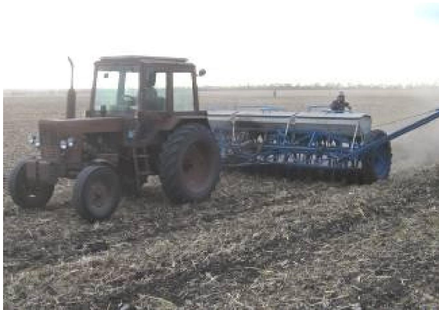
Рисунок 3.1 – Сівалка зернотукова СЗ-5,4 в агрегаті з трактором МТЗ-82
