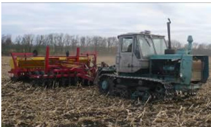
Рисунок 3.3 – Зернотукова сівалка СЗК-4,5 в агрегаті з трактором Т-150
