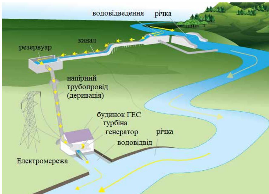
Рис. 1. Дериваційна схема створення напору на гідроелектростанції
