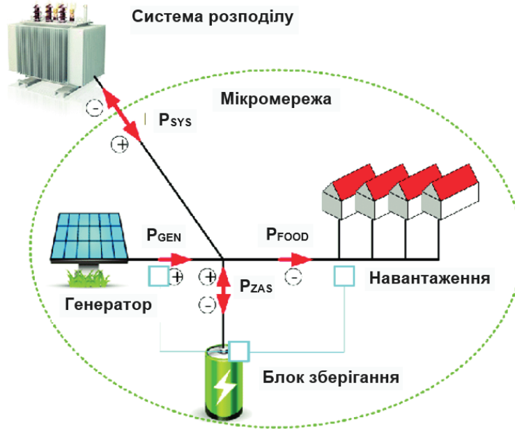
Рис. 1. Типова схема мікромережі
