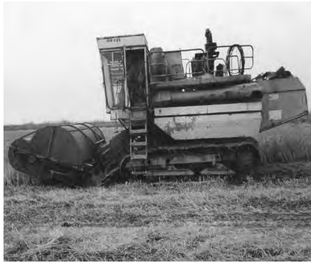
Рисунок 2. Зернозбиральний комбайн обчісувального типу з різальним пристроєм
