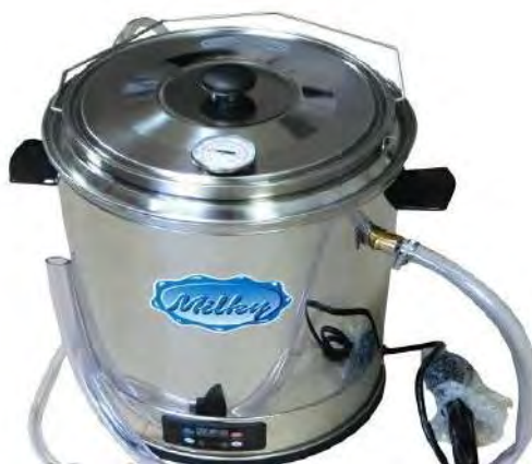
Рисунок 2. Мініпастеризатор-сироварня марки FJ 15
