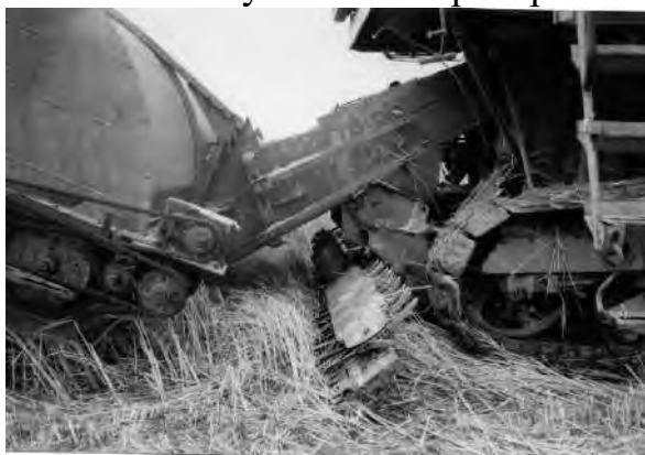
Рисунок 4. Ріжучий пристрій сегментного типу з транспортуючим механізмом
