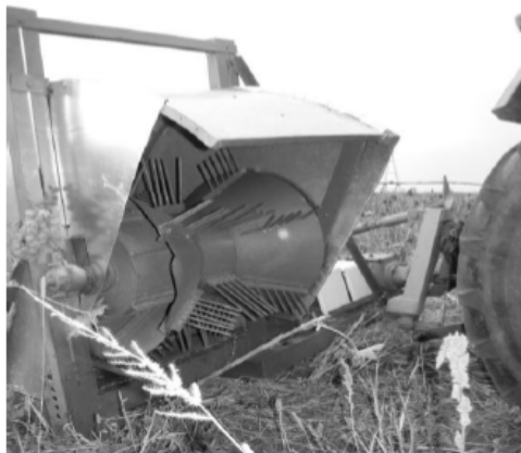
Рис. 5. Конічний робочий орган з жорсткими гребінками
