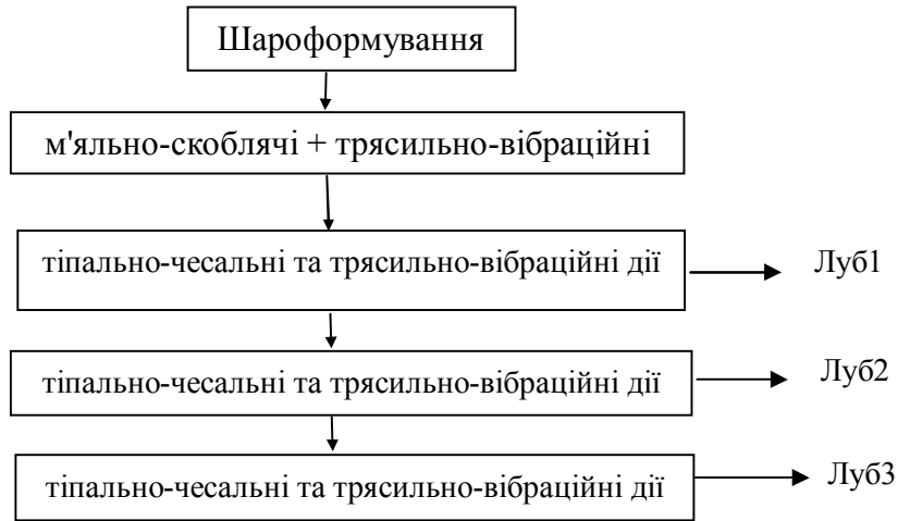
Рис. 1. Схема технологічного процесу виділення лубу конопель
