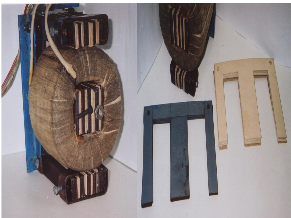
Рис. 3.26. Технология шихтовки электромагнитного сепаратора.
