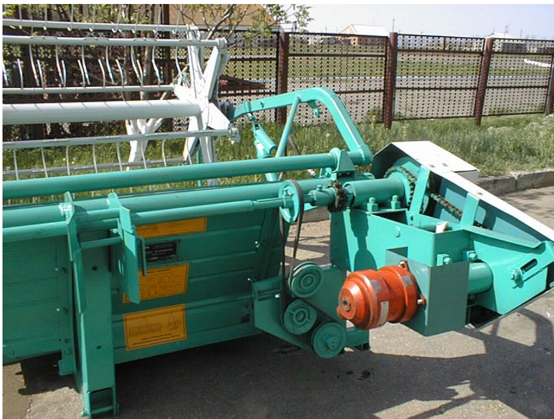
Рис. 4.8. Гидрообъемный привод активных рабочих органов жатки.
