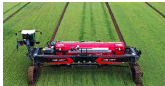
Рис. 2. Колійна система землеробства з використанням ширококолієних (мостових) тракторів
