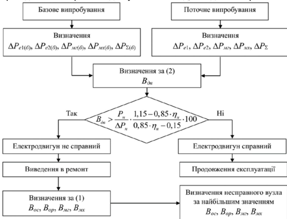
Рис. 1. Блок-схема періодичного контролю функціонального стану приводного асинхронного двигуна.
