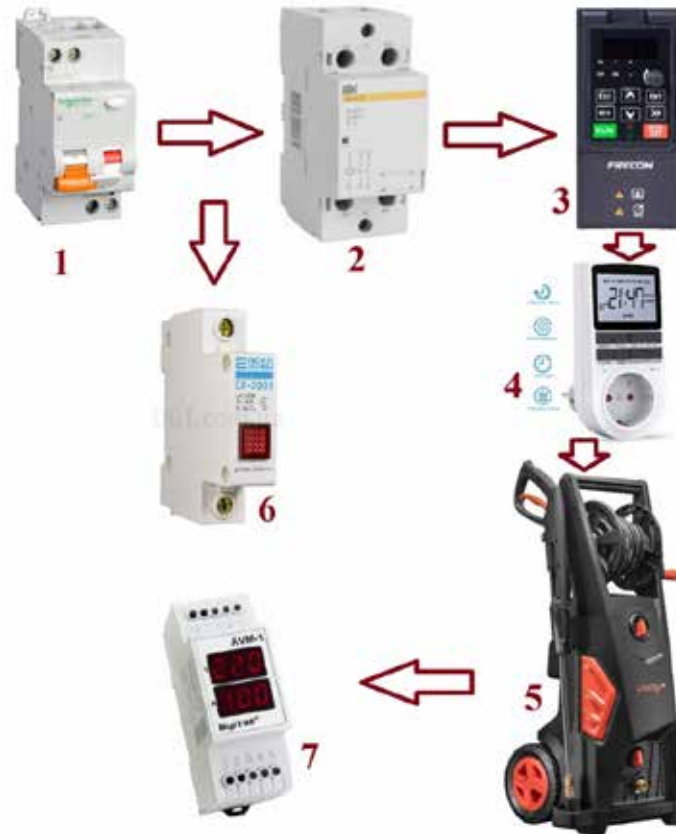
Рис. 1. Структурна схема щита мийки транспортних засобів 1 – диференційний автоматичний вимикач, 2 – електромагнітний пускач, 3 – перетворювач частоти, 4 – розетка з затримкою на вмикання та вимикання, 5 – мийка високого тиску, 6 – індикатор, 7 – амперовольтметр
