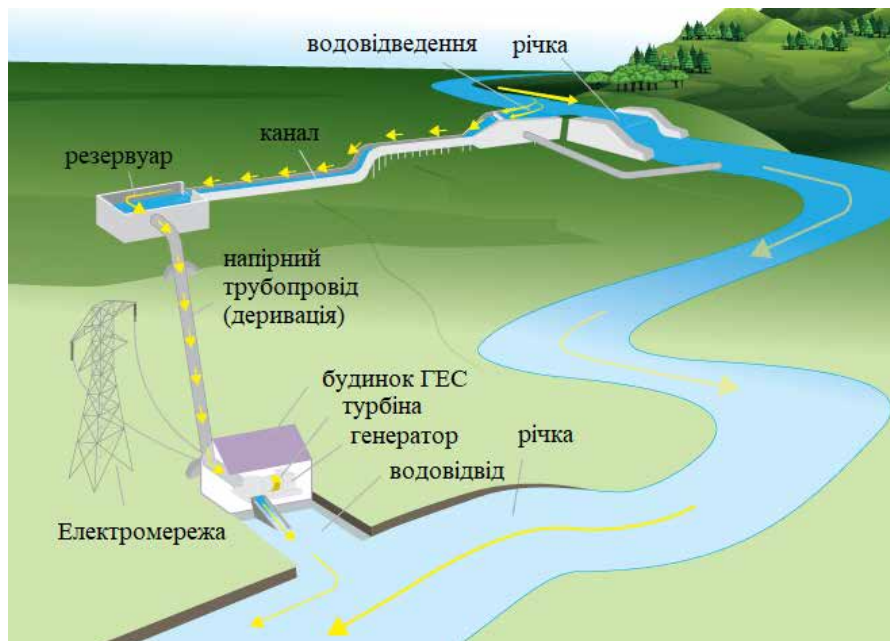
Рис. 1. Дериваційна схема створення напору на гідроелектростанції
